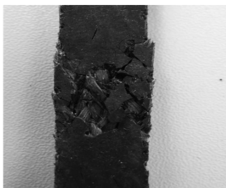
(a) 三维五向 3D 复合材料冲击破坏断口形貌
