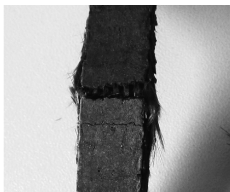
(b) 正交三向 3D 复合材料冲击破坏断口形貌
