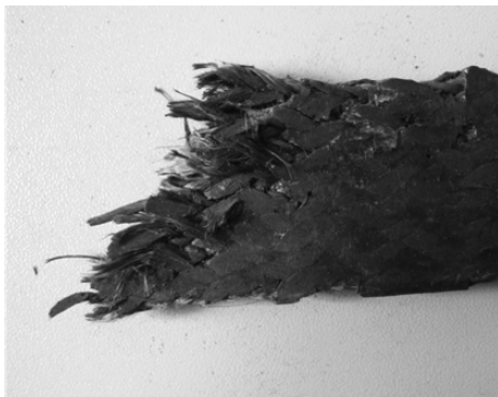
(a) 三维五向3D复合材料拉伸破坏断口形貌
