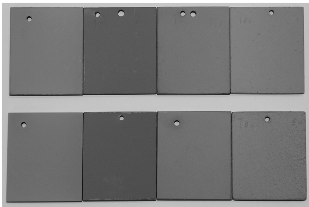
图 3 正脉冲及正负脉冲式样的表观形貌
