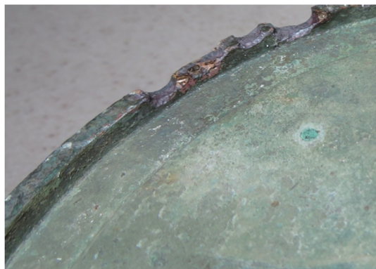
图7 密封面中间部位腐蚀破损
