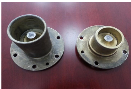
图 2 断裂的超扭保护轴
