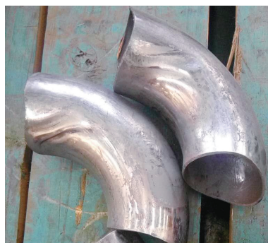
图5 铜镍合金管从弯管试验起皱图
